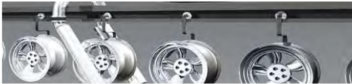
國內某知名輪圈大廠，原先在輪圈塗裝線使用一台500HP的空壓機為水洗後的輪圈進行乾燥，由於能耗驚人客戶希望能夠降低生產成本，我們經過仔細的評估後，向客戶提出一套具體的解決方案，我們使用一台SONIC 350/50HP的鼓風機，搭配六支SONIC鋁合金高效率均壓風刀、一個一對六岐管及成套配管零件，成功取代原有的乾燥系統，而且乾燥效果比舊系統來的更好，更重要的是我們成功為客戶省下巨額的能耗與電費，讓客戶感到非常滿意。
